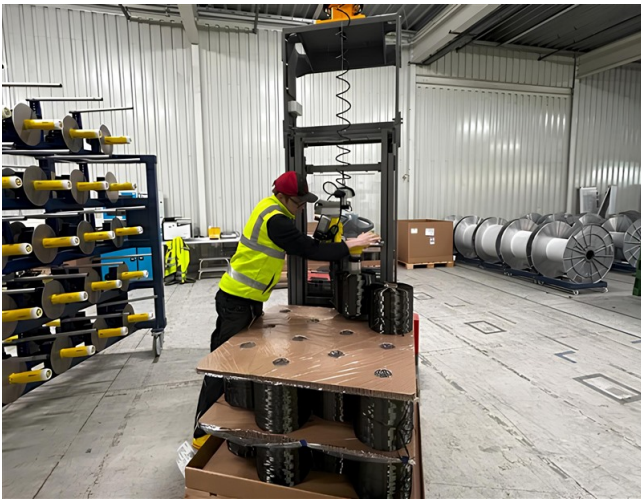
Carbonspule mit der Handlingshilfe vertikal aufnehmen.
