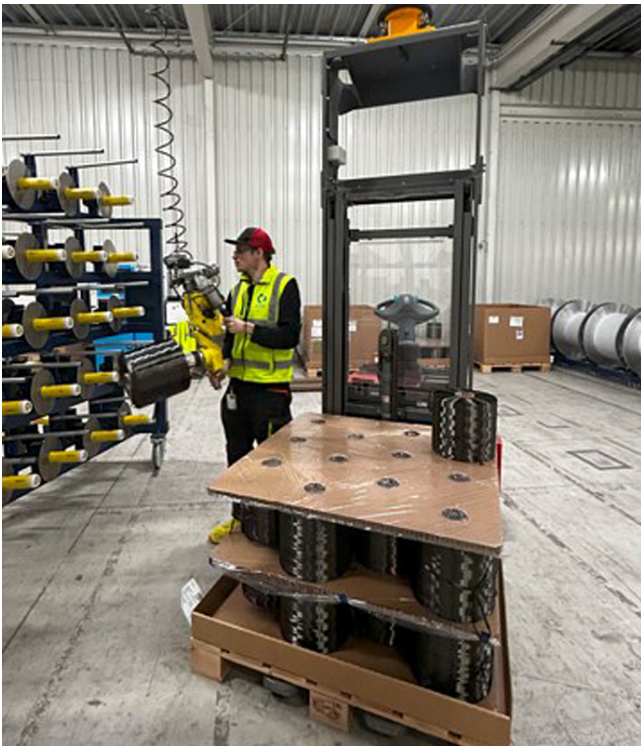
Mit der Carbonspule zum Gatter gehen.
