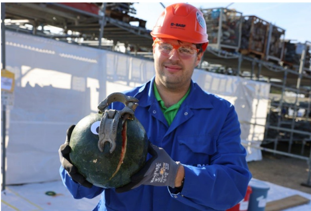
Michi-Melone nach Einschlag einer Gerüstbaukupplung
