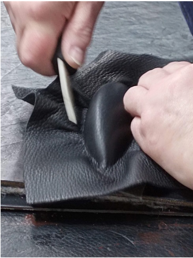
Ergonomisches Falzbein Typ 6 in Nutzung
