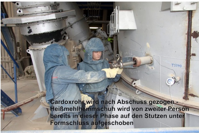
Phase 1: Ziehen, Cardoxrohr und bereits aufgesteckter Hemmschuh
