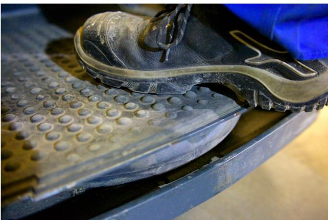
Sorgt bei jedem Überfahren für Rückenbelastungen: Der Höhenunterschied zwischen LKW und Boden der Lagerhalle.
