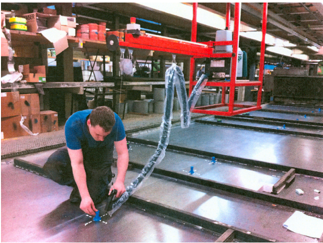
Mitlaufende Tankanlage im Einsatz
