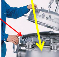
Möglichkeit des Austritts von heißem Dicksaft
