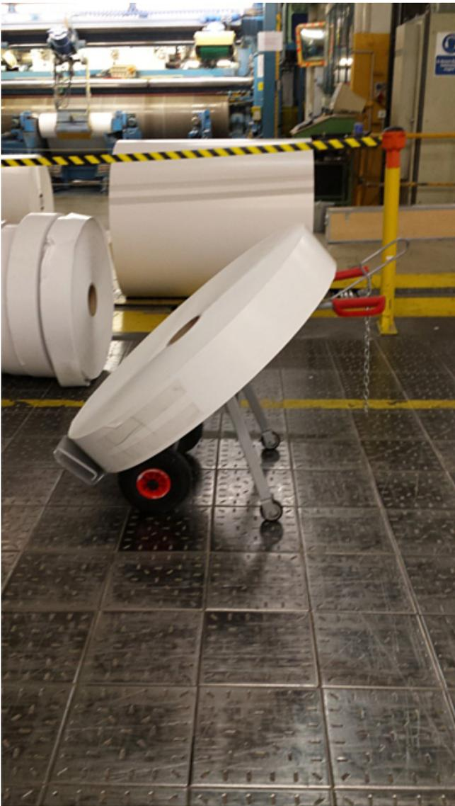
Zum Abladen der Rolle Transporteinrichtung aufstellen, Sicherung ziehen und Transporteinrichtung unter der Rolle hervorfahren.
