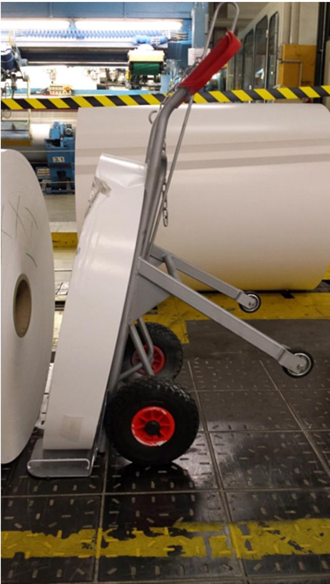
Im zweiten Schritt wird nun die Rolle angelegt und mit dem Sicherheitsbügel ...
