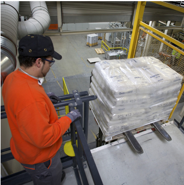
Absturzsicherung im betrieblichen Einsatz - Schiebeter geöffnet, Zugangstür mechanisch verriegelt
