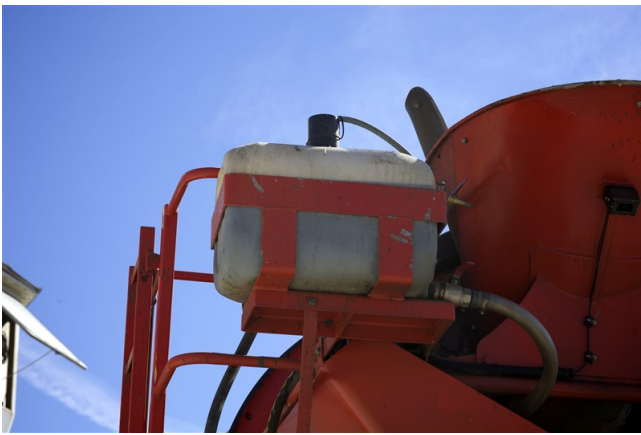
zu befüllender Fließmittelbehälter auf dem Fahrmischer
