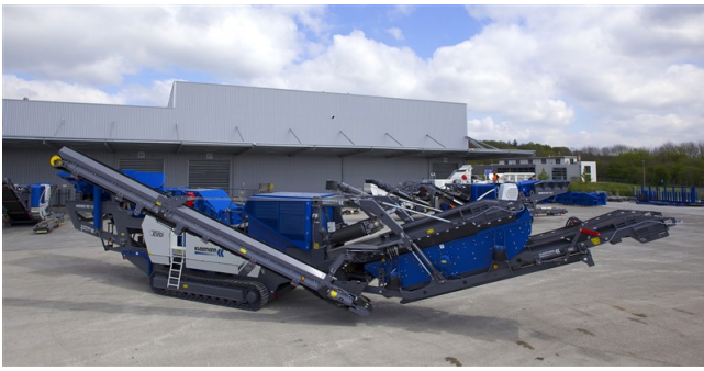
Mobiler Prallbrecher Mobirex EVO2 von Kleemann
