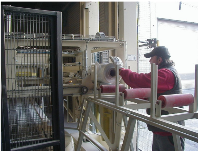
Arretierung nach unten geklappt und Folienrolle in den Plattenwickler geschoben
