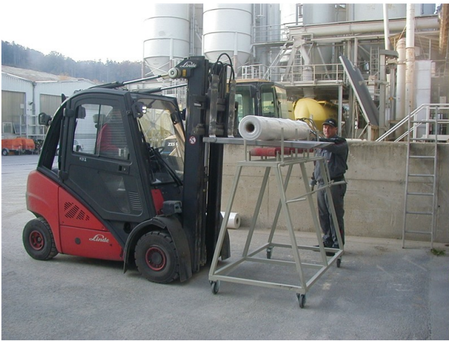
Folienrolle wird mit einem Gabelstapler auf die Einrichtung gehoben
