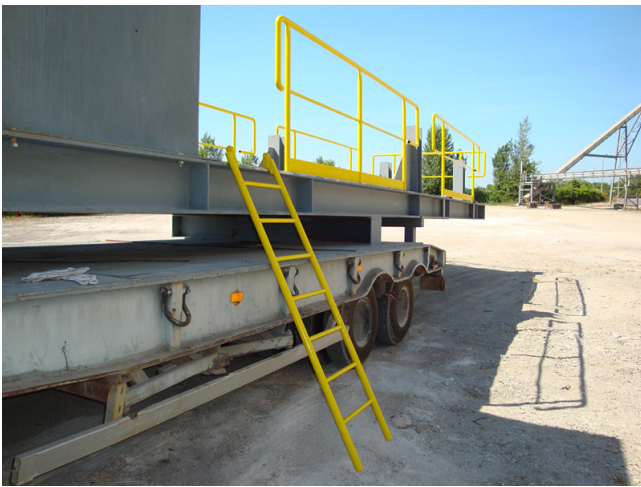
Hänger mit Aufstieg und Absturzsicherung
