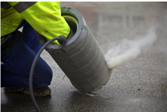
Die Luftfilter wurden bisher mit Druckluft von Hand gereinigt. Dabei wurden gesundheits-schädliche Feinstäube freigesetzt.
