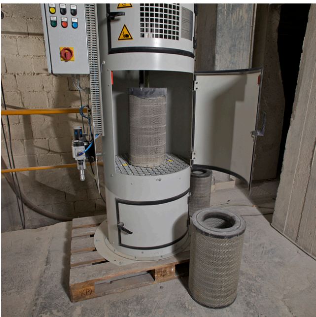
Eine rotierende Druckluftdüse reinigt die Luftfilterpatronen in einem geschlossenen System nach einem voreingestelltem Programm. Staubpartikel werden abgesaugt und größere Verschmutzungspartikel in einer Wanne aufgefangen.
