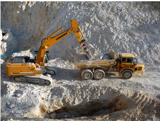
Kieselerdeabbau bei der HOFFMANN MINERAL GmbH. Die Staubfilter der großen Erdbaumaschinen müssen mehrmals wöchentlich gereinigt werden.
