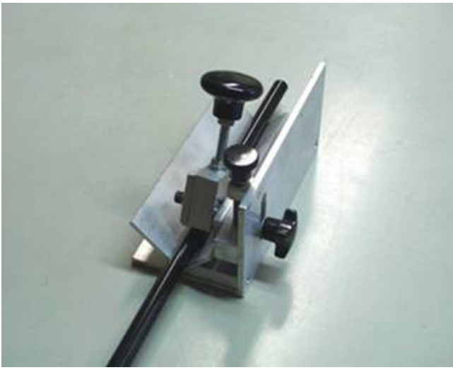
Variante der Schlitzvorrichtung für die Entfernung von Dornen
