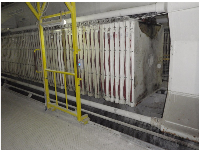
Abb. 3: Das neu entwickelte verfahrbare Schutzgestell neben der offenen Presse
