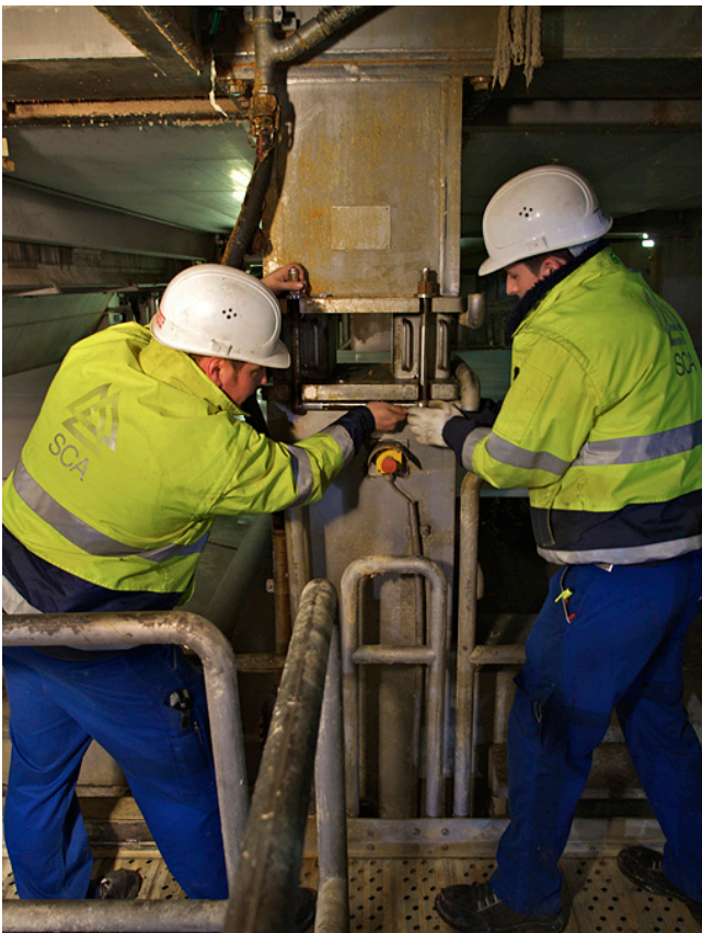
... müssen beim Bespannungswechsel der riesigen Maschinen zur Papierherstellung teilweise abgebaut werden. Das erhöht das Unfallrisiko.
