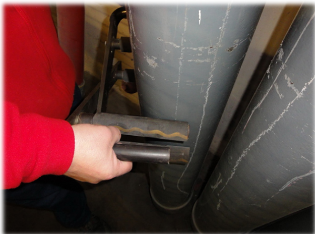
Der „Flaschenheber“ wird um die Flasche gelegt, durch das Anheben wird diese Flasche eingeklemmt.
