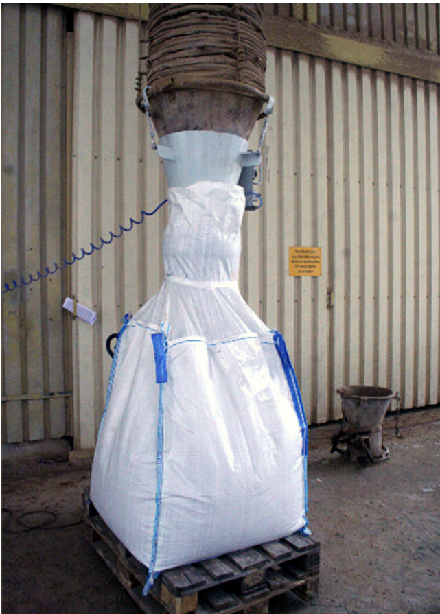
Druckluftmanschette wird in Betrieb genommen und schließt den Big Bag staubdicht ab.
