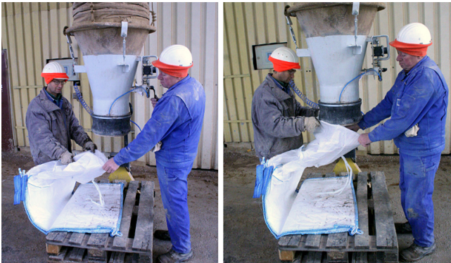
Big Bag Installation / Big Bag wird über Druckluftmanschette geschoben.
