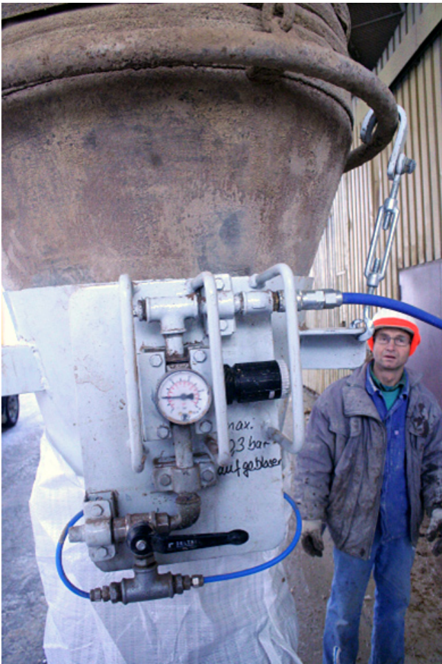
Druckluftmanschette wird in Betrieb genommen und schließt den Big Bag staubdicht ab.
