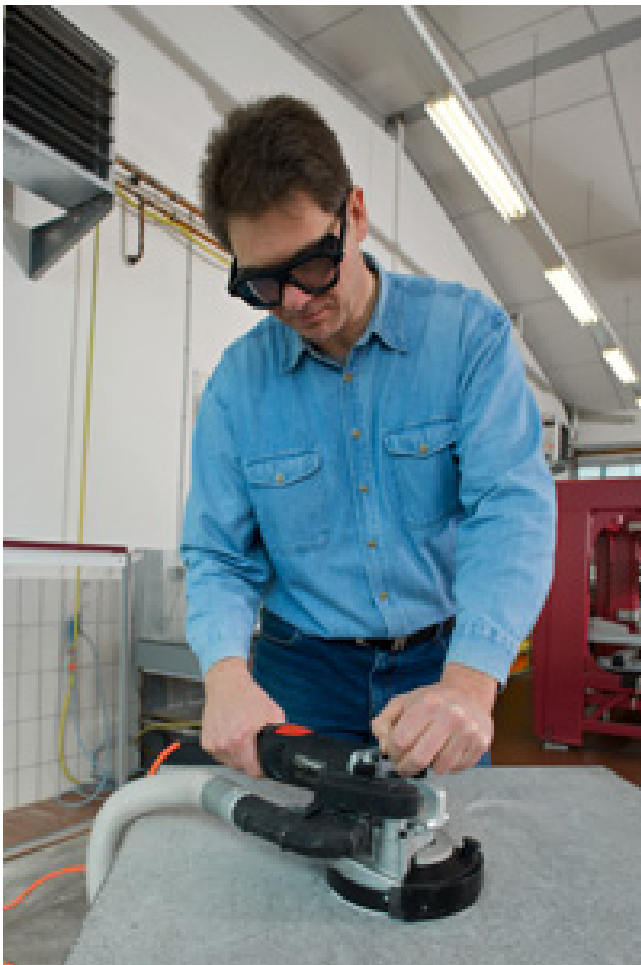
Staubabsaugung beim Schleifen einer Natursteinplatte
