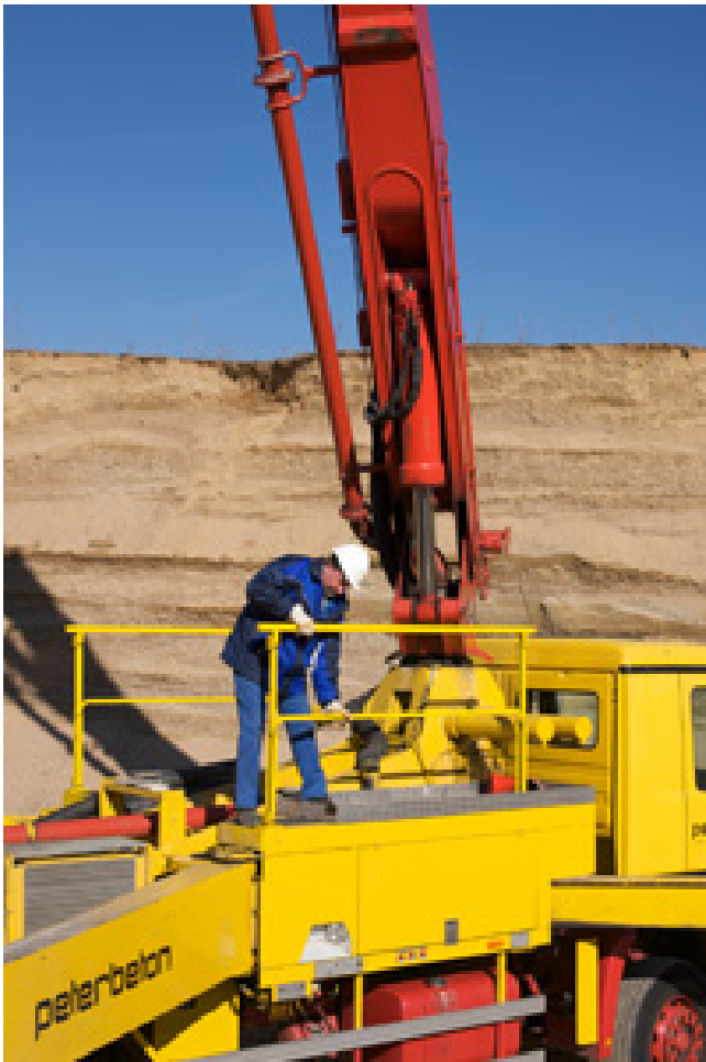
Montage der Absturzsicherung
