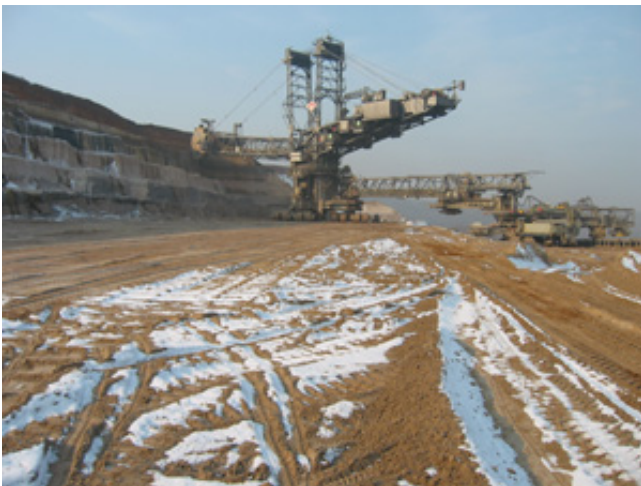
Schaufelradbagger im Einsatz
