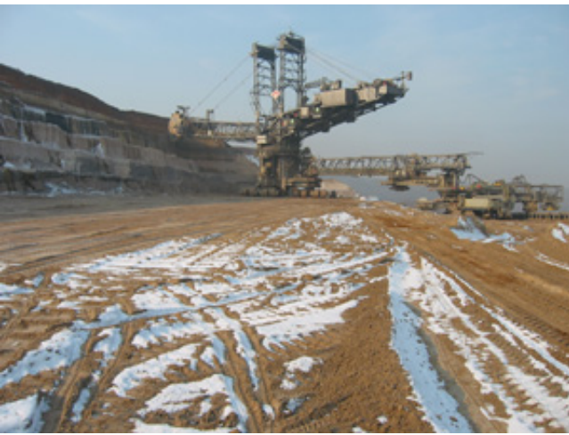
Schaufelradbagger im Einsatz
