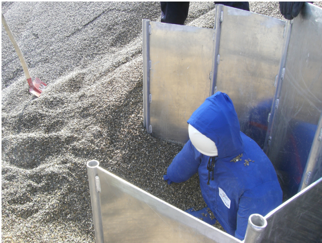
Die Schubverbindungen der Bleche ermöglichen einen schnellen Einsatz. Foto: BG RCI
