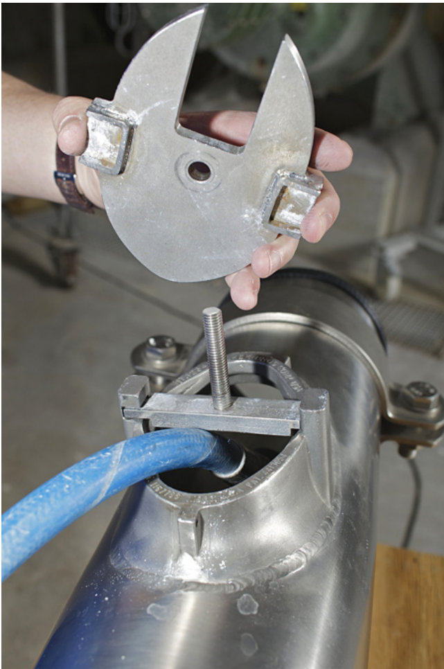
Das Schlauchende mit der Düse bleibt in der Reinigungsöffnung. Foto: BG RCI/Plöger
