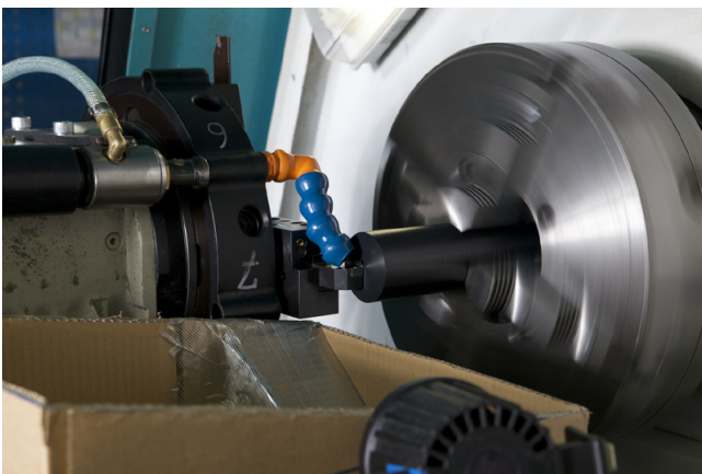
Die ausgeklügelte Absaugvorrichtung im Einsatz an der wechselbaren Werkzeughalterung. Foto: bgrci/Plöger
