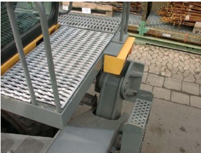
Laufroste und Aufstieg
